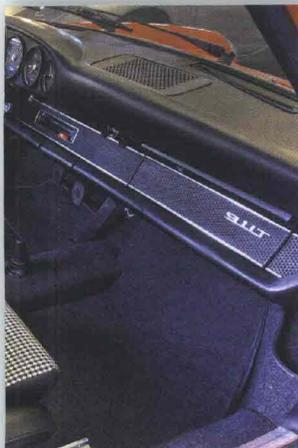
*Particolari del cruscotto con l'inconfondibile caratteristica dei cinque strumenti allineati con il contagiri al centro, tipico delle vetture sportive. Qui a destra, lo sportello di chiusura del vano portaoggetti con l'indicazione della sigla modello*
