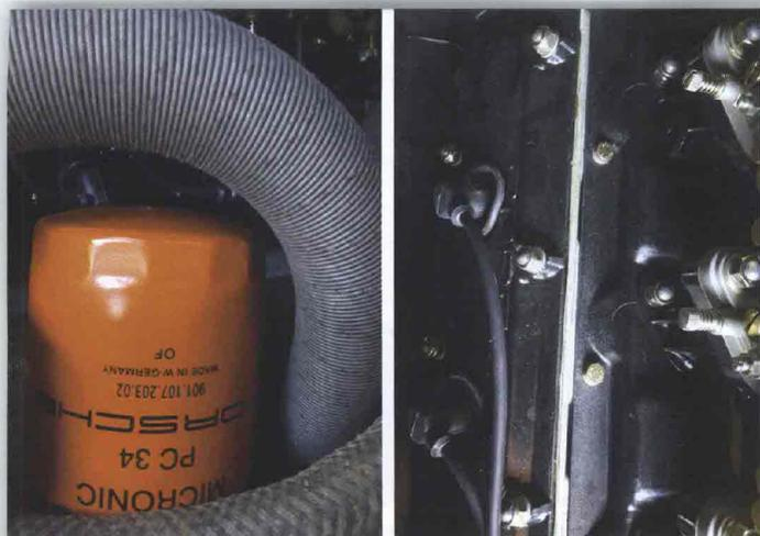
*In questa pagina, particolari del motore: da sinistra, il filtro dell'olio, una parte del coperchio delle punterie della bancata di sinistra e i carburatori Weber 40 IDTP con la bobina*
