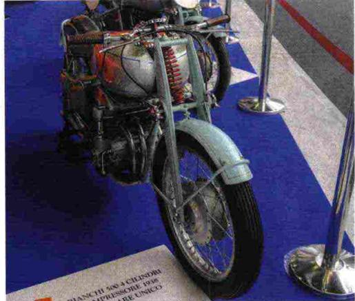
L'Aprilia RSW 250 vincitrice nel 1996 con Max Biaggi del titolo iridato della quarto di litro. A destra, dalla collezione Righini, la Bianchi 500 quattro cilindri bialbero, sovralimentata con un compressore volumetrico a palette, provata nel 1939 da Alberto Ascari e mai utilizzata in gara.
