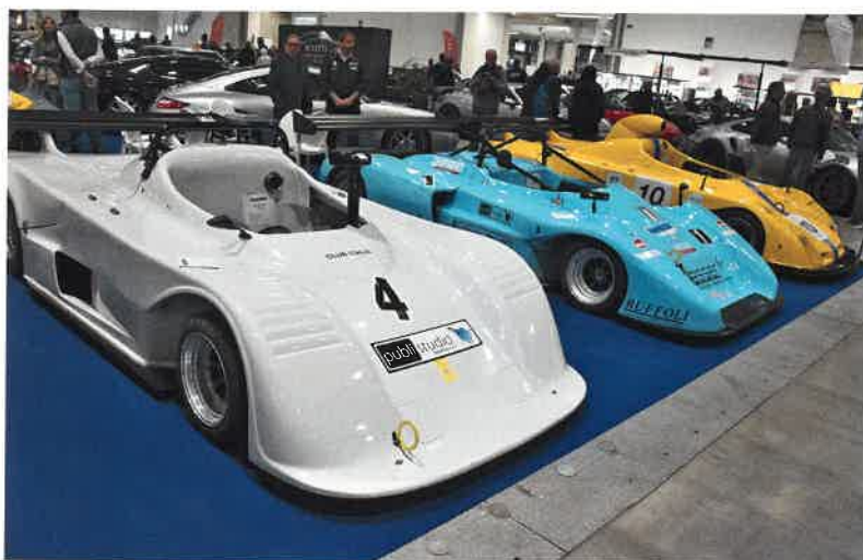
Spidery Osella: bílý je jedním ze tří postavených PA/N z roku 1990, má třílitrový motor Alfa Romeo. Modrý PA 9/90 z roku 1986 má dvoulitrový motor BMW M12, stejně jako žlutý PA 5 z roku 1977
