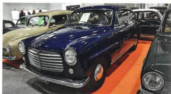
Na Turínském autosalonu 1950 Fiat představil typ 1400, který byl jeho prvním automobilem zkonstruovaným po druhé světové válce, a zároveň jeho prvním s celokovovou samonosnou karosérií
