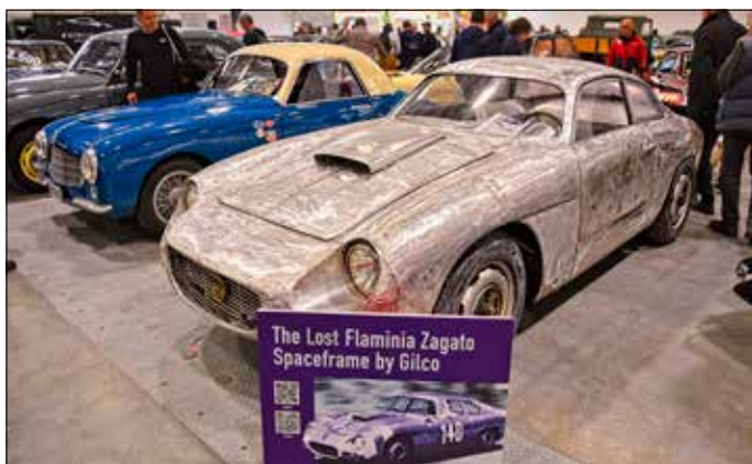
Lancia Flaminia Zagato (1962) byla určena pro Targa Florio téhož roku. Podařilo se najít originál. Nyní dostává původní podobu. Výrazný podíl tehdy ležel na bedrech Gilberta Colomba, jehož GILCO dodávalo bezpečnostní rámy z ohýbaných chromolybdenových trubek většině italských výrobců závodních aut
