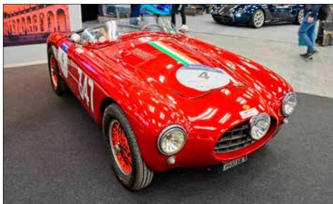
Ermini 1100 Sport Internazionale (1952) s karoserií Motto, šasi č. 055352 modifikoval Gilco. Celkem vznikly tři identické stroje. Bojovaly v Mille Miglia a Targa Florio (1952), Coppa d'Oro delle Golomiti (1953). Motor 1096 cm 3 (88 k) se dvěma horizontálními webery si vzal do práce Ermini
