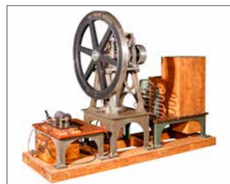
Funkční novostavba motoru Barsanti & Matteucci (originál pocházel z roku 1853)
