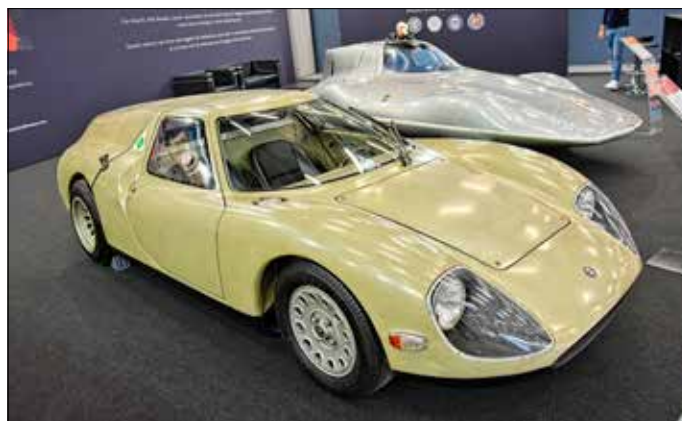
Alfa Romeo Scarabeo (1966) vychází ze šasi „Tipo 33“, jak je připravila milánská závodní divize Autodelta. Řadový čtyřválec 1570 cm 3 (115 k) dovozoval dosáhnout rychlosti až 200 km/h. Karoserii dodala karosárna OSI. Scarabeo obdivovala Paříž 1966. Vzadu Abarth 750 Record (Turín 1956) ze skicáře Nuccia Bertone
